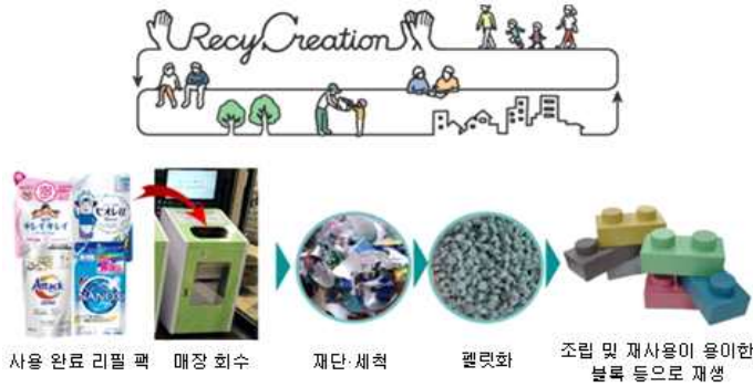
[그림 32] 가오·라이언 사용이 끝난 플라스틱 필름 용기의 회수·재활용 실증실험
